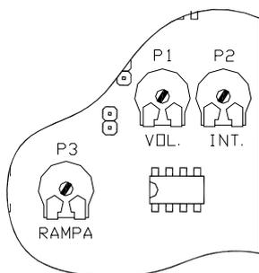
**P1:** Potenciómetro de ajuste de tensión máxima (limita la tensión en la posición máxima del cursor del potenciómetro de regulación de tensión).
